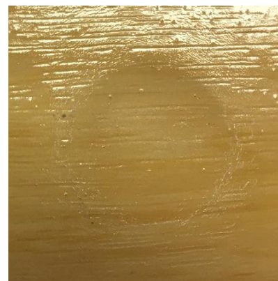
30\text{kg}/\text{cm}^2 負荷後のワレ状態
