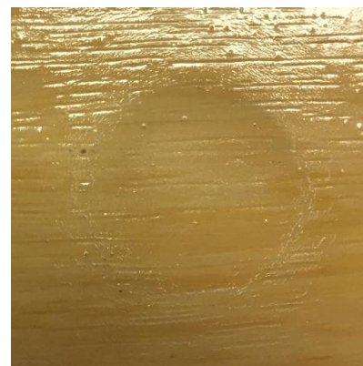
30\text{kg}/\text{cm}^2 負荷後のワレ状態
